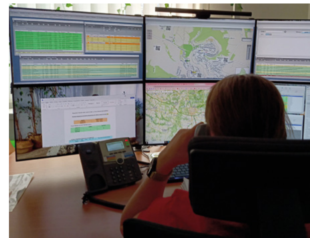
Dispečerka na monitorech sleduje aktuální polohy a zpoždění vozidel, má přehled o návaznostech, u nichž hrozí nedodržení, vidí textové zprávy od řidičů a vozidel a má přehled o aktuálních obězích vozidel. V případě potřeby vysílá na vozidla včetně vlaků textové zprávy, kterými nastaví např. délku čekání nad nastavené limity.
