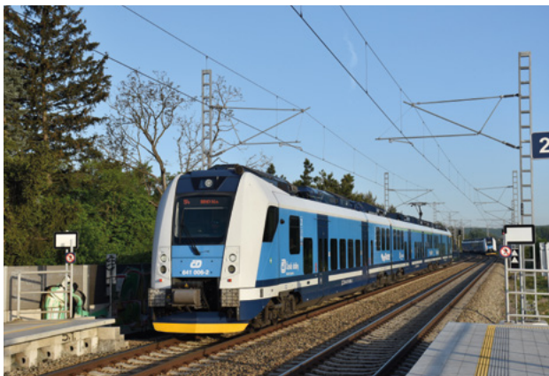
Elektrické Jednotky RegioPanter na vlacích linky S4 poblíž zastávky Ostopovice. V roce 2024 byla dokončena modernizace tratě mezi Brnem a Zastávkou u Brna, která zahrnovala mj. zdvoukolejnění a elektrizaci. Na lince S4 tak mohlo dojít k navýšení rozsahu dopravy a k nasazení moderních elektrických jednotek.
