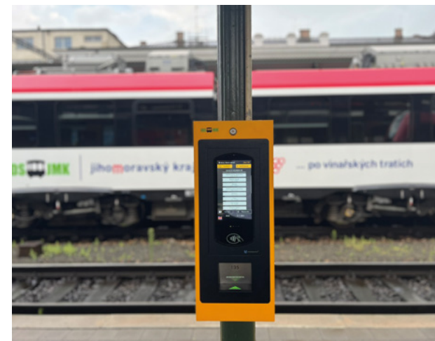
KORDIS nejprve na brněnských nádražích a posléze na všech nádražích IDS JMK instaloval nové validátory. Prodají elektronické jízdenky IDS JMK nejenom v režimu jízdenkového automatu, ale samy určí potřebnou jízdenku na základě vyhledaného spojení, zobrazí aktuální odjezdy, mimořádnosti v dopravě i polohu spojů na mapě.
