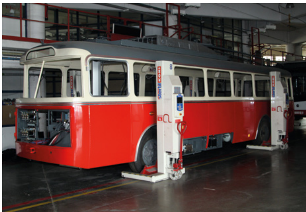
Rekonstrukce historického trolejbusu 9Tr (Škoda).
