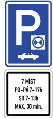
Vzorový vzhled dopravního značení krátkodobého obrátkového parkování.
