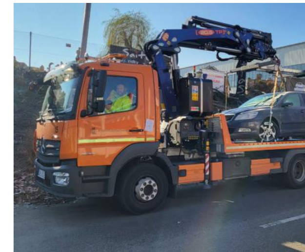
Odtahové vozidlo s plošinou a HNJ.
