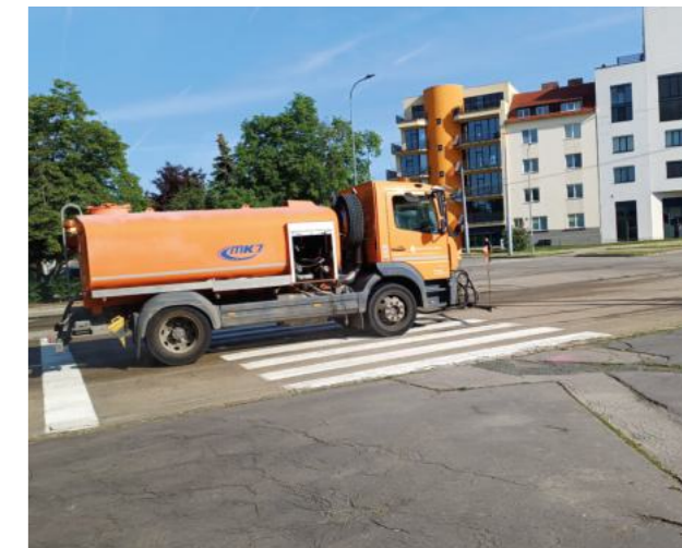
Tlakové splachování komunikací.
