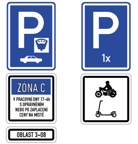
Vzorový vzhled dopravního značení parkovacích stání pro motocykly a koloběžky.
