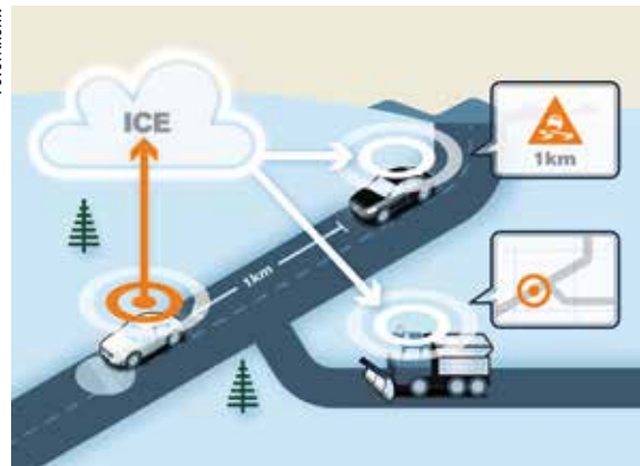
■ Při chytré komunikaci se budou sdílet data o počasí a stavu vozovky se všemi dopravními prostředky v okolí.
